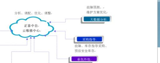
**实现：**采用云平台部署方式，解决多个水厂通讯网络搭建难题。对现有各厂各自为政的管理模式进行颠覆性管理，集成GIS地图，以2小时车程为半径，建立集中维修处理中心，为管辖范围的生产单位提供设备维修维护服务，实现资源集中，人员共享优化，任务统一调配，作业质量统一考核，并提供设备外购时机、安全库存数量、维护保养周期、设备故障预测等智能决策指导。
